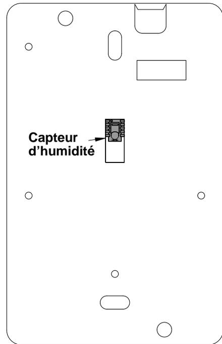
Fig. 1b Vue arrière d'un hygrostat de conduit
