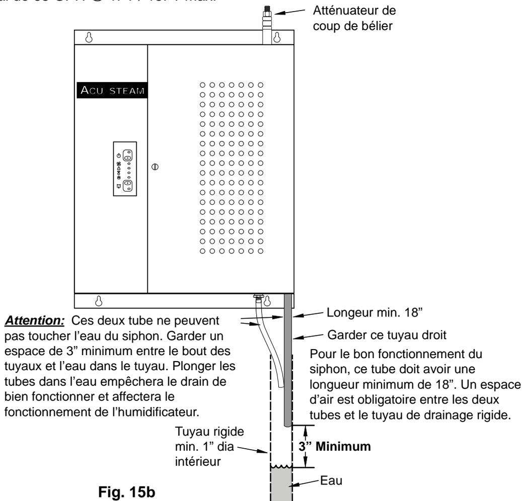
15.6 Comme cet appareil est équipé de capteurs de niveau d'eau, il est important de l'installer de niveau de gauche à droite et d'avant en arrière.
