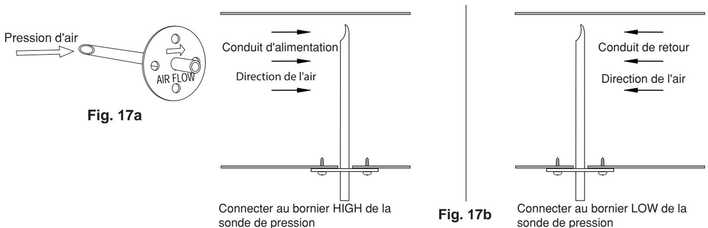
17.5 Poussez une extrémité du tuyau de plastique sur la sortie de la sonde. Passez et connectez l'autre extrémité du tuyau sur l'entrée "High" de l'interrupteur de débit d'air situé sous la carte électronique. Si la sonde est installée dans la gaine de retour, connectez le tuyau sur l'entrée "Low" de l'interrupteur de débit d'air.
