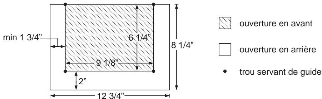
14.2 L'ouverture en arrière du mur doit être plus large de 1 3/4" de chaque côté, plus bas de 2" au bas du rectangle et à niveau avec le haut du rectangle. Tracer ce nouveau rectangle et le couper à l'aide d'une scie.
