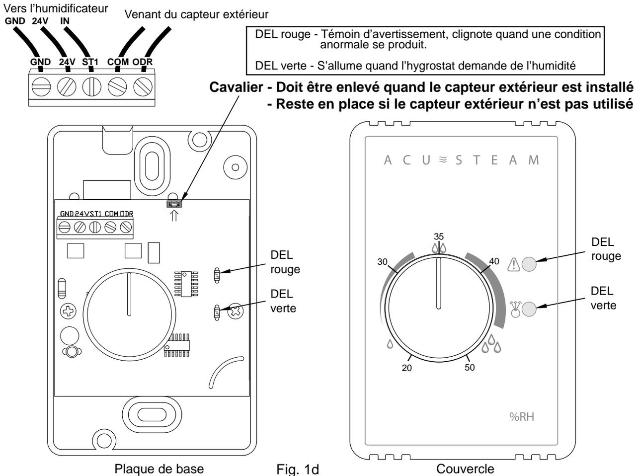
**IMPORTANT** : Dès qu'un capteur extérieur est raccordé à l'hygrostat électronique, **le cavalier placé en haut du circuit électronique de l'hygrostat doit être enlevé** (i.e. le cavalier court-circuite les deux bornes dédiées au capteur). Si le capteur extérieur n'est pas installé, **laissez le cavalier en place**.
